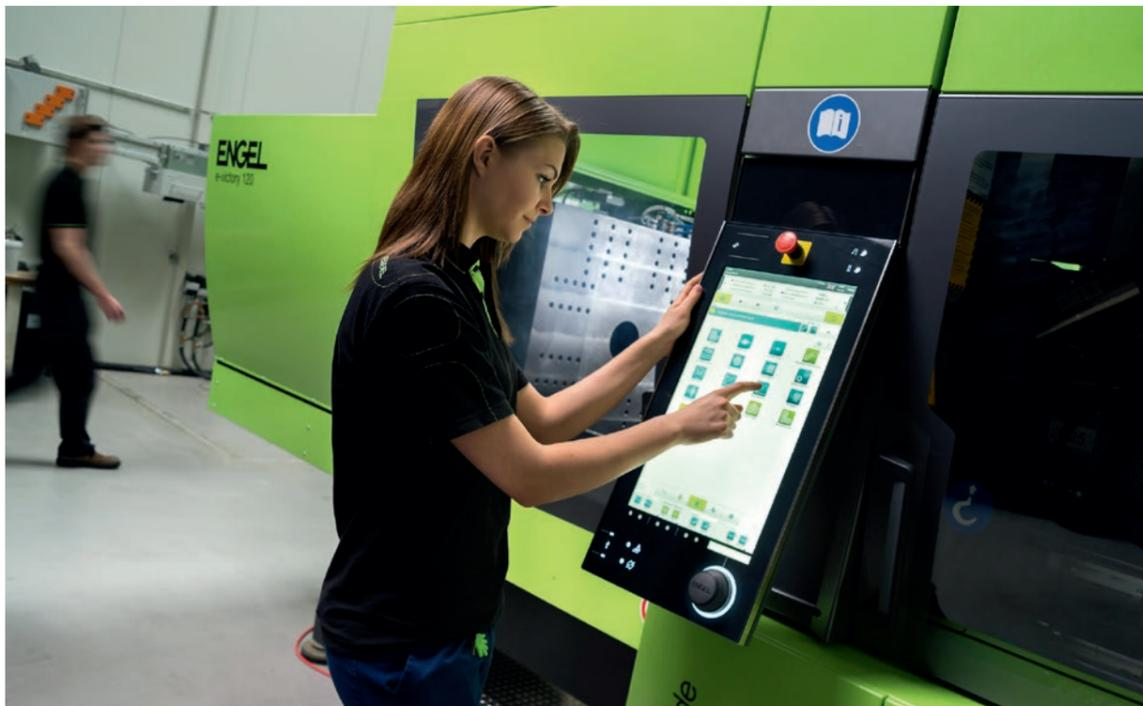
Über die CC300 Steuerung der Spritzgießmaschinen lässt sich die komplette Fertigungszelle steuern.
