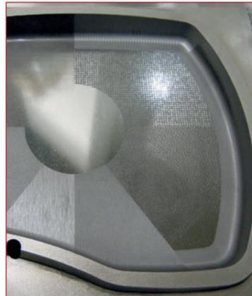
exakte Reproduktion der Oberfläche eine Herausforderung dar. Ziel muss es daher sein, die erzeugten Designoberflächen im Spritzgießwerkzeug mittels der heute verfügbaren technischen Möglichkeiten bestmöglich vor einem Verschleiß sowie einer Schädigung zu schützen.
